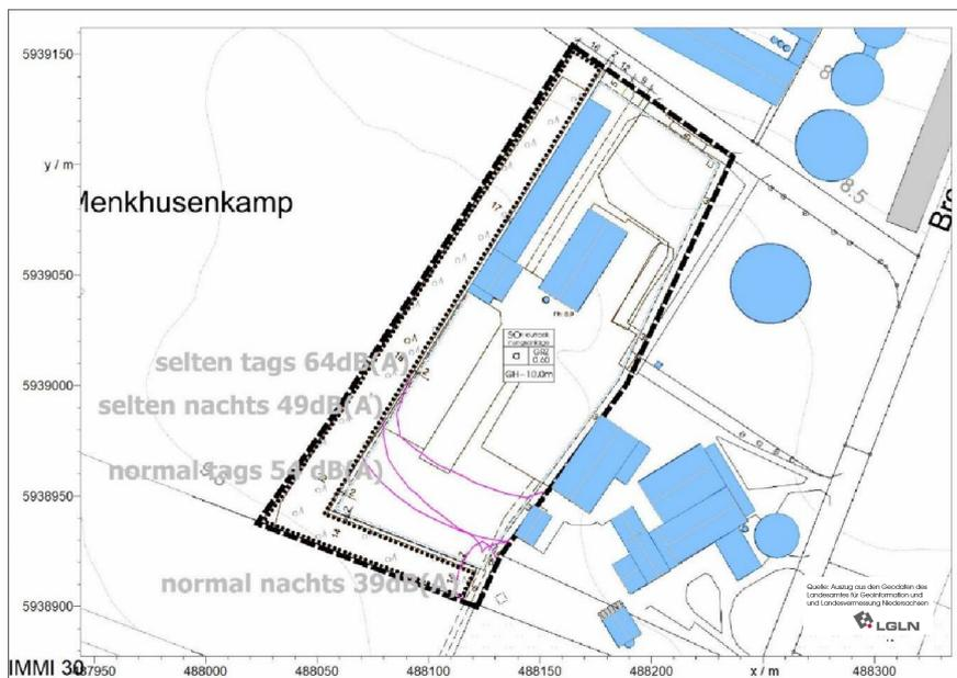
**Abb. 10:** Aus den jeweiligen Raster-Berechnungen ermittelte Isolinien (pink) für die Zielwerte, jeweils 6 dB(A) unterhalb der jeweiligen Immissionsrichtwerte für den Normalbetrieb sowie den Betrieb während der Erntezeit (angesetzte Rasterhöhe: 5,5 m).
