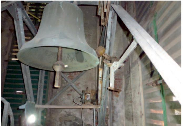
gebaut hatte. Das hat aber nicht immer gut funktioniert, da die Abschaltung des Motors, wenn das Gewicht oben angekommen war, auch nicht genau stattfand. So waren einige Schäden an dem Uhrwerk entstanden die zwischendurch auch repariert wurden.
