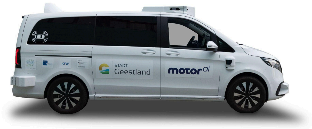
Ein Mercedes-Benz EQV, umgebaut von MOTOR Ai für das autonome Fahren nach Level 4 (Foto: MOTOR Ai)
