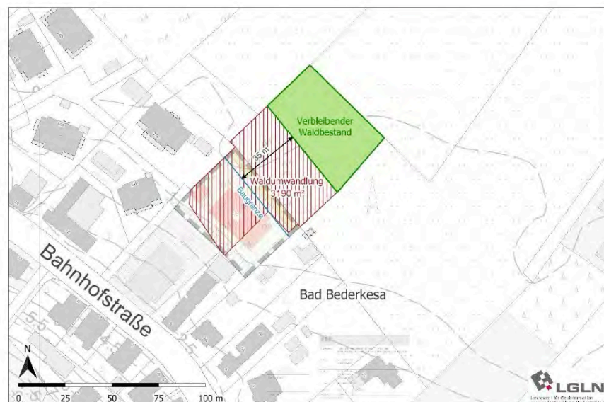
Abb. 2: Ermittlung der Größe der von Waldumwandlung betroffenen Fläche unter Berücksichtigung der geplanten Baugrenze und des in der Praxis gebotenen Waldabstands von 35 m (M 1:2.000)
