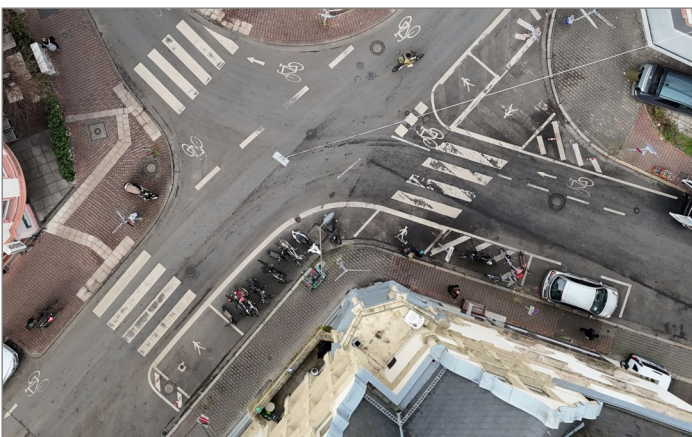
Abbildung 2: Wartepflichtige und bevorrechtigte Überquerungsstellen mit vorgezogenem Seitenraum innerhalb eines Knotenpunktes (eigene Aufnahme)
