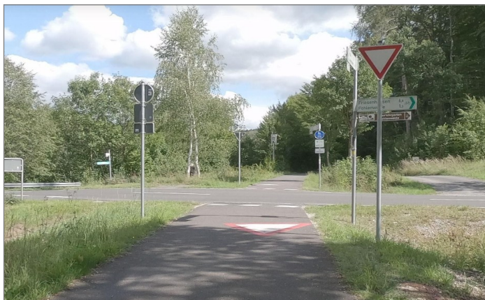
Abbildung 2: Bodenmarkierung und eindeutige Beschilderung im Vorfeld einer wartepflichtigen Überquerung einer Straße (eigene Aufnahme)
